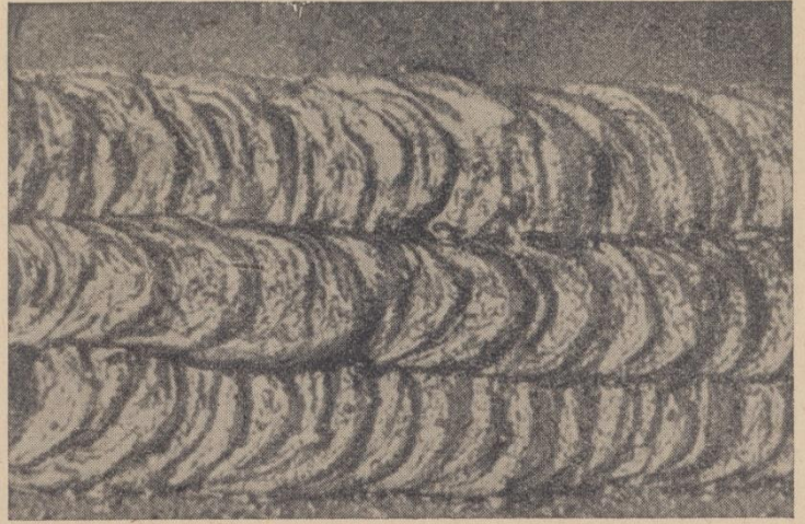
Bild 3 a. An der Schweißraupe sind keine Rißbildungen zu erkennen.
